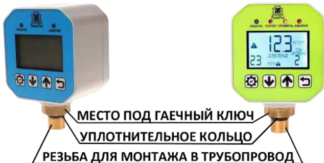
Рисунок 1. Схема монтажа на трубу.
